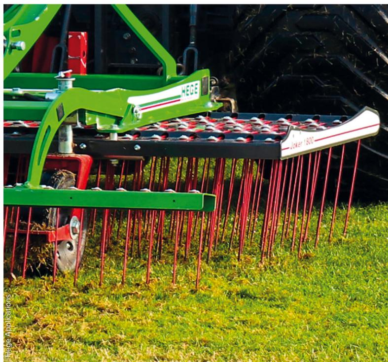
Si l'épaisseur du feutre dépasse le centimètre, le Joker d'Hege Applications entre en jeu, avec des dents de 7 mm de diamètre (5 mm en version standard).
