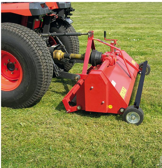
Le défeuteur-scarificateur DF d'Yvmo intègre 43, 50 ou 76 lames disposées en hélicoïdale, évitant ainsi les vibrations et le bruit tout en nécessitant moins de puissance moteur. L'entraînement est réalisé par des tracteurs de faible puissance (à partir de 14 cv).
