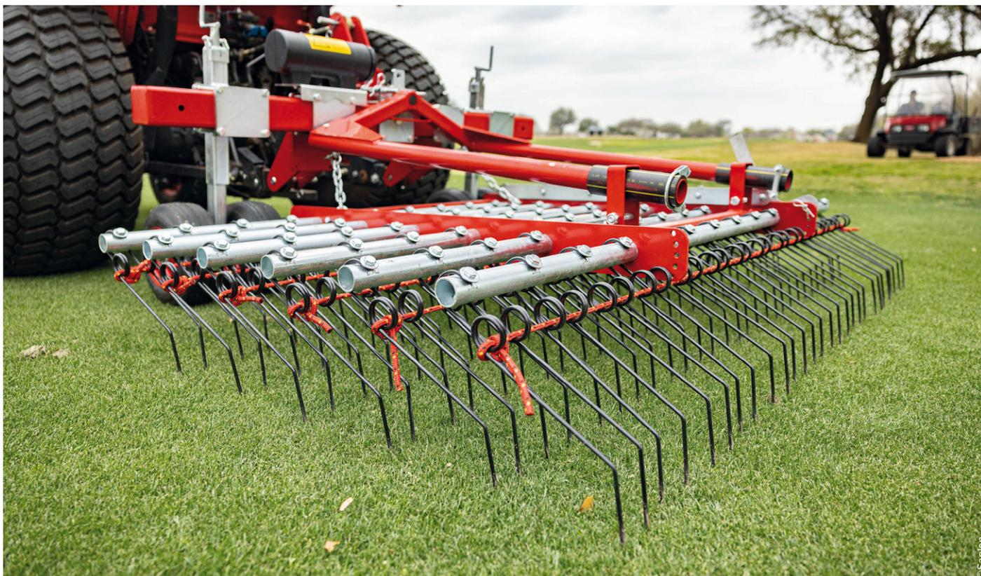
Le défeuteur Verti-Rake de Redexim, proposé par Saelen, possède des dents de 6 mm de diamètre. Sa manette de réglage d'agressivité comporte cinq positions. C'est une machine dont la rapidité (8-10 km/h) garantit l'efficacité de travail en assurant l'oscillation rapide des dents de droite à gauche.
