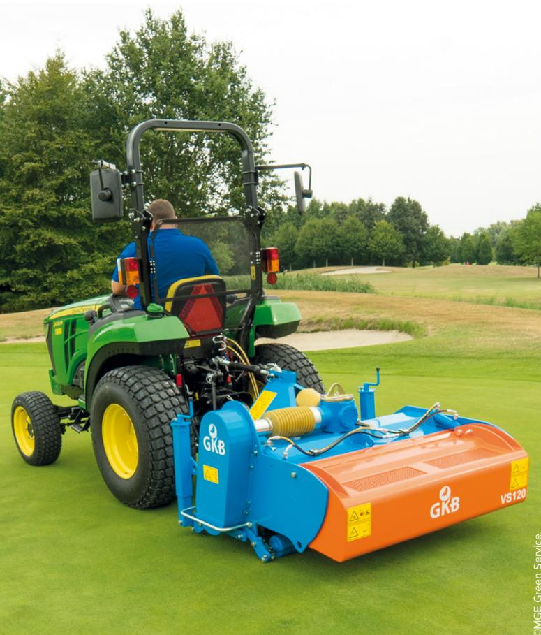
Le défeuteur à lames Vstrong de GKB (distribution MGE Green Service) se distingue par un rotor entraîné par la prise de force du tracteur. Les modèles VS120 et VS160 peuvent également être équipés d'un bac de ramassage en option.
