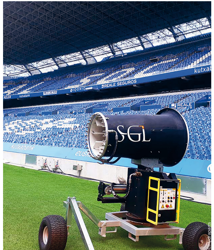
Posés sur les abords du stade, des ventilateurs ‘assèchent’ le gazon et limitent ainsi la durée d’humectation des feuilles, facteur de développement de la pyriculariose.
