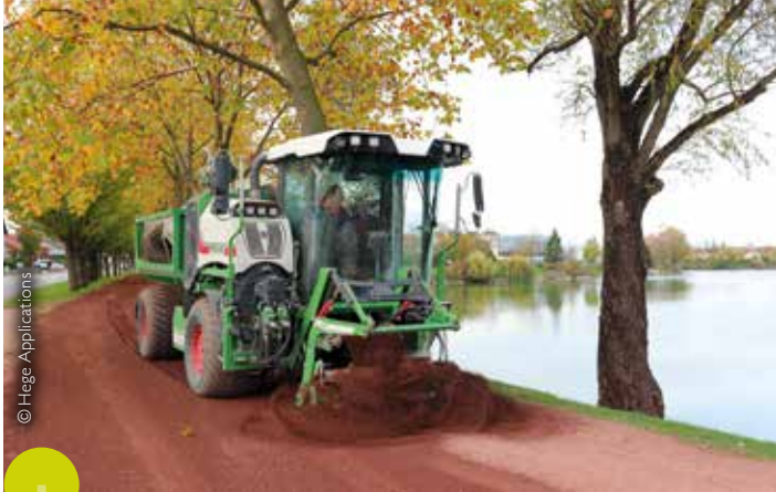
L'une des premières créations, le Golf Trac 2010, utilisé pour les travaux de drainage.
