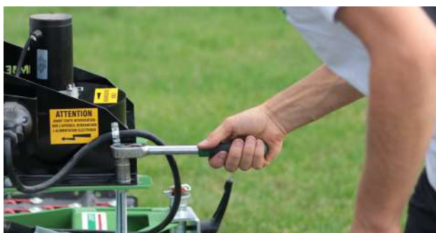
Fixer le semoir sur le support.
