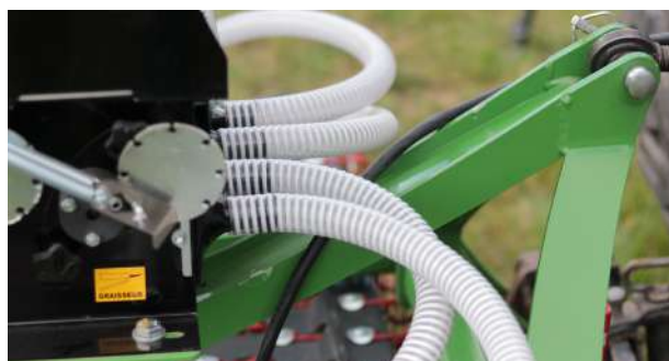
Raccorder les 4 tuyaux au semoir.
