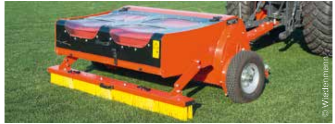
Attelée à un porte-outil de 16 cv, la Terra Clean 100 de Wiedenmann est une machine sur roue qui nettoie et crible les déchets et résidus surfaciques. Elle possède un balai constitué de 8 supports de brosses. Des griffes, situées à l'avant, assurent un léger décompactage sur 1 cm de profondeur.
