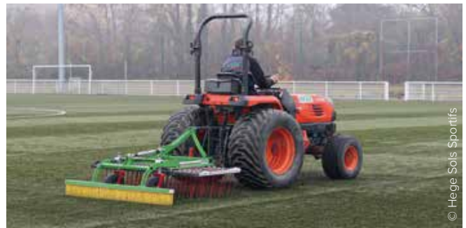
L'efficacité du Joker, fabriqué par Hege Sol Sportifs, est liée à la densité des "dents ressorts" sur le plateau : 184 dents/m². Equipé d'un kit 'brosse' à l'arrière, cet outil permet de redresser les fibres, décompacter, égaliser et redistribuer les granulats de remplissage.
