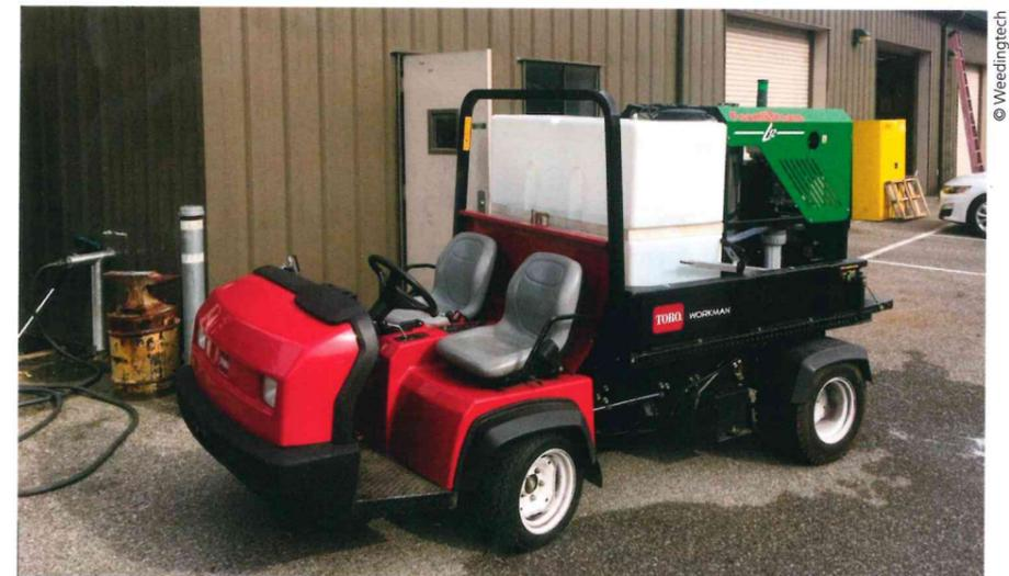
Compact, le désherbeur à mousse biodégradable L12 de Weedintech est transportable, par exemple, sur le plateau d'un Workman. Une fois le moteur en route (alimenté par du sans plomb ou du propane), l'eau est chauffée en moins de 45 secondes.
