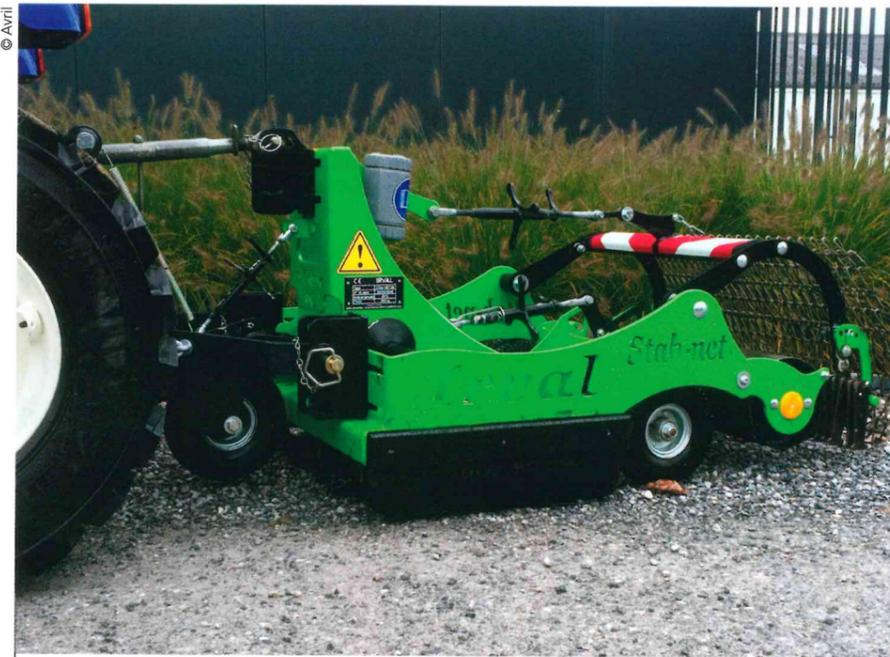
Tracté, le Stabnet90 d'Avril amenuise la réserve de graines en dormance dans le sol, aplanit les surfaces, décaisse les allées et ameublit la couche superficielle du sol. Largeur de travail : 90 cm.
