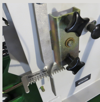
Réglage du cylindre en fonction de la taille de la graine.
