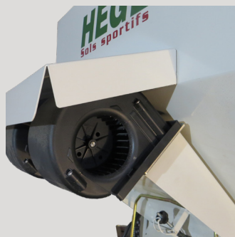
Ventilateur électrique assurant la distribution de la graine.
