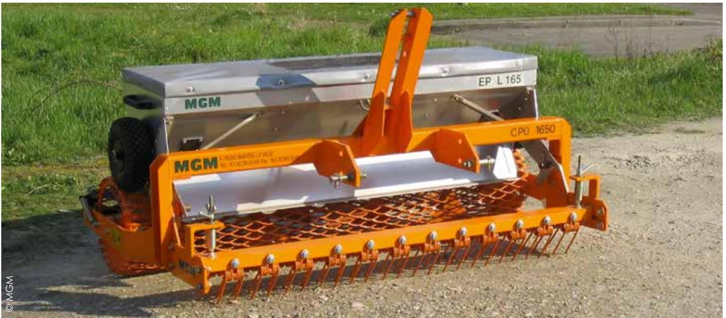
**Le Motrac de MGM est composé d'un châssis porte-outils muni d'un rouleau affineur et d'un engazonneur en inox. Cet ensemble permet la réalisation de semis rapide sur des terrains préparés au préalable (jusqu'à 10 km/h). Dans certains cas, il peut être utilisé pour des travaux de regarnissage.**
