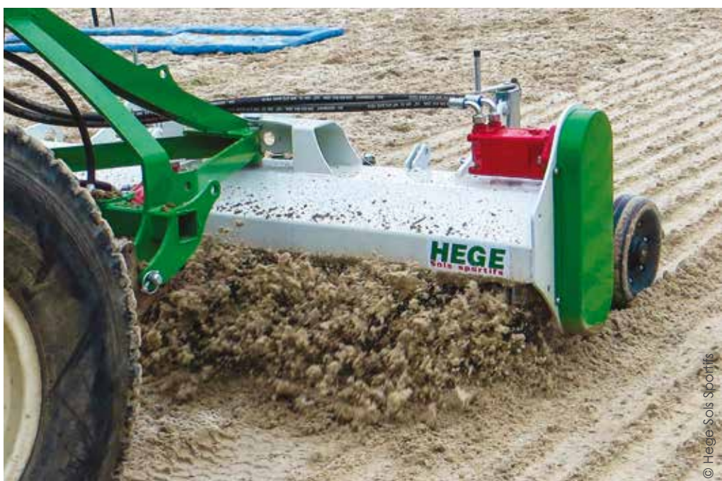
Fabriqué par Hege Sols Sportifs, le 'Perfecto 95' est un râteau mécanique qui décompacte et aère la matière sur moins de 5 cm afin de maintenir la souplesse et la perméabilité du sol. Il homogénéise et mélange les divers composants, nivelle et stabilise la surface à l'aide de roues mobiles pivotantes.
