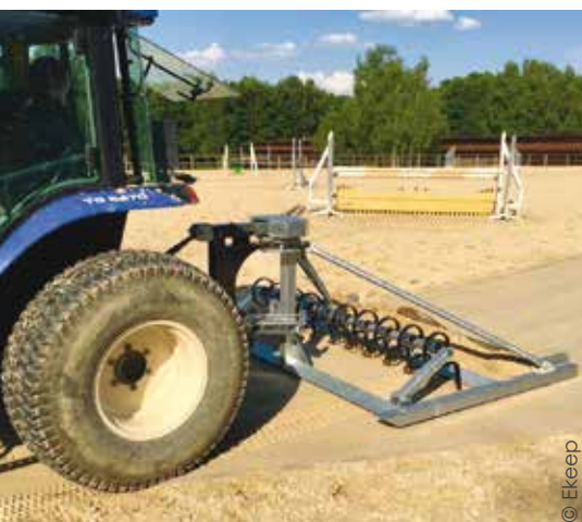
Conçue par la société Ekeep, cette herse pour tracteur est destinée à l'entretien des sols fibrés ou non. Avec son attelage à tête pivotante, les angles de la piste, habituellement inaccessibles, sont désormais lissés et le sable nettement moins amoncelé en bordure.
