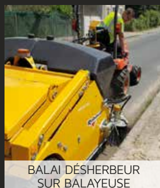
BROSSE DE DÉSHÉRBAGE MÉCANIQUE
