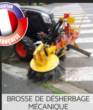
BALAI DÉSHÉRBEUR SUR BALAYEUSE
