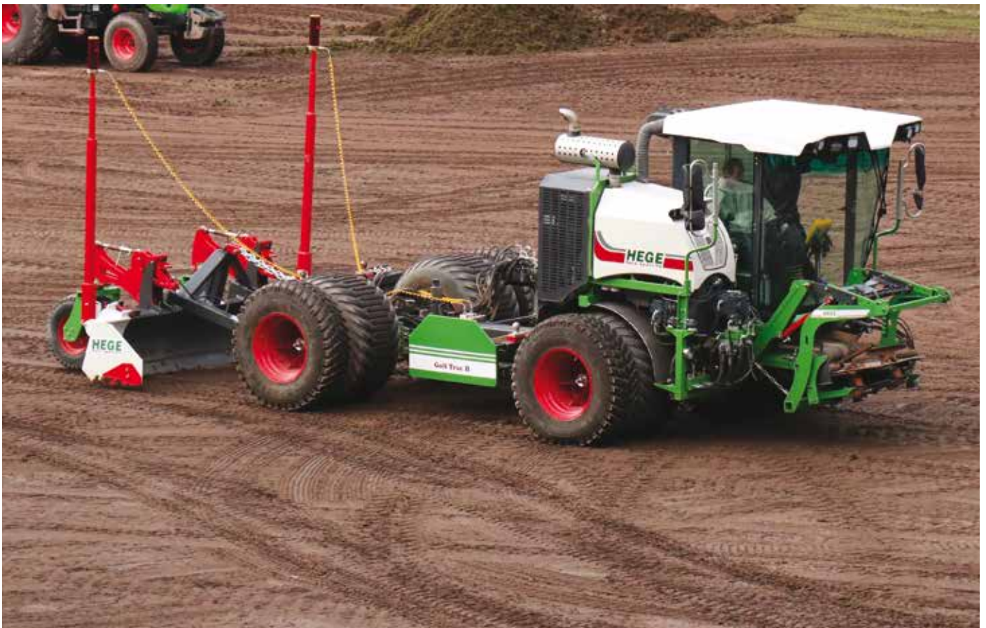
A titre d'exemple, un prototype polyvalent, ici en mode "nivellement laser".
