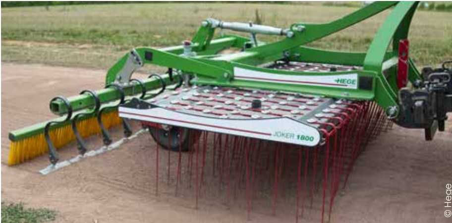
C'est la combinaison du plateau de dents, du système de couteaux et du balai qui assure l'efficacité des opérations de désherbage et de nivellement.
