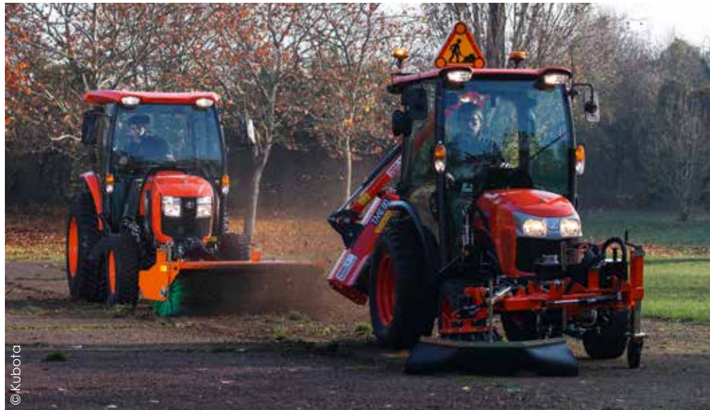
Commandées par un système hydraulique, les brosses peuvent être réglées facilement, y compris celles disposées sur les côtés du porte-outils.
