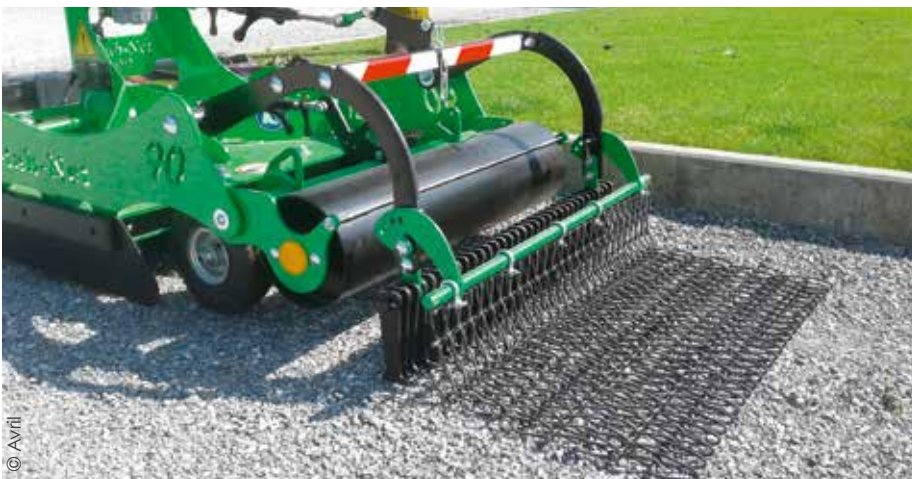
Les pièces d'usure en acier spécial sont auto-affûtantes et conçues pour le désherbage, l'entretien et le curatif. Elles peuvent être changées une à deux fois par an (coût : de 190 à 280 € HT/an), pour 8 à 20 ha de surfaces désherbées, soit un coût de remplacement inférieur à 0,01 €/m 2 .
