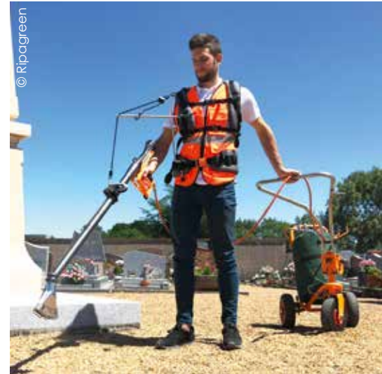
Pour désherber efficacement, il ne faut surtout pas insister et brûler le végétal, mais uniquement lui donner un 'coup de chaud' (environ 80°C dans l'épaisseur de la feuille). Le processus de photosynthèse sera alors stoppé et la plante desséchera.
