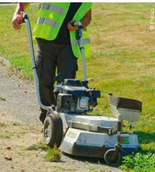
Des protections latérales permettent de désherber 'proprement'.
